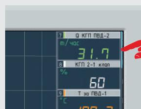
Гибкое масштабирование элементов вывода данных измерений в зависимости от их числа на экране, возможность прокрутки элементов на экране;
