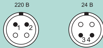
Подключение питания для исполнений ПИ1226-Х-Х-Х-Х-2-Х
