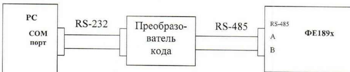
Рисунок 1. – Схема подключения «Преобразователя кода RS-232–RS-485»
