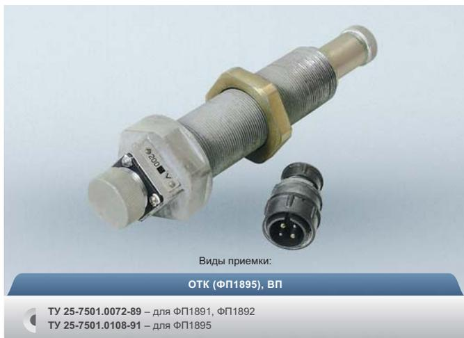
**i** Первичные тахометрические преобразователи первичные предназначены для преобразования частоты вращения зубчатых ферромагнитных роторов в электрические сигналы, используемые в тахометрических системах.
