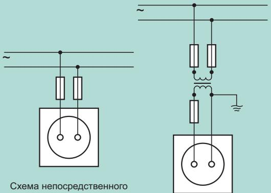
Схема непосредственного подключения к сети вольтметров.
