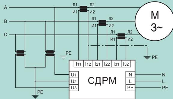
Подключение с 3-мя трансформаторами тока и 3-мя трансформаторами напряжения, напряжение свыше 0,4 кВ
