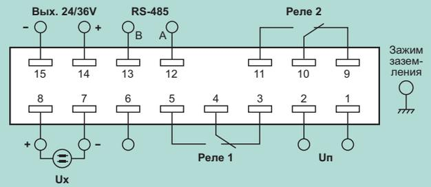
Схема внешних соединений приборов при измерении напряжений.
