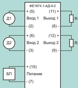
Схема подключения двухканального преобразователя с питанием внешних датчиков. Двухпроводная схема подключения преобразователя к датчикам с диапазоном 4 – 20 мА. Питание датчика осуществляется по токовой петле. (ФЕ1874.1-АД-9-2)
