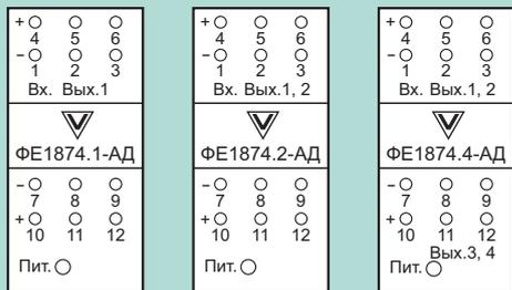
Схема подключения преобразователей с питанием внешних датчиков:
