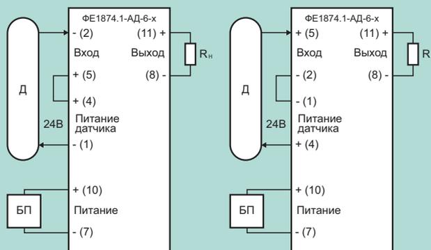
Схема подключения преобразователя с питанием внешнего датчика. Двухпроводная схема подключения преобразователя к датчику с диапазоном 4 – 20 мА. (ФЕ1874.1-АД-6-х)
