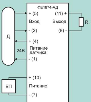
Схема подключения преобразователя с питанием внешнего датчика. Четырёхпроводная схема подключения преобразователя к датчику. (ФЕ1874.1-АД-5-х ... ФЕ1874.1-АД-8-х)
