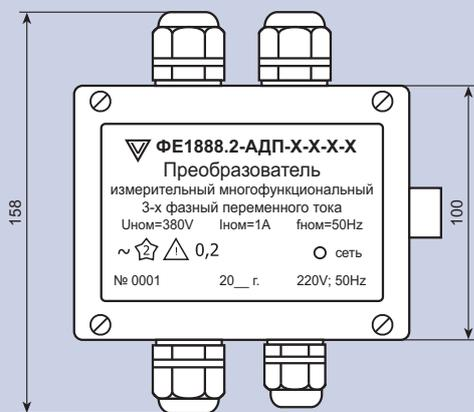
Преобразователь с коммутационным блоком типа Б
