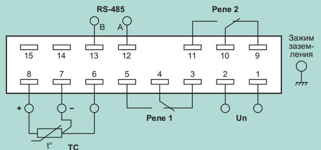
Схема внешних соединений приборов с термопреобразователем сопротивления (ТС).
