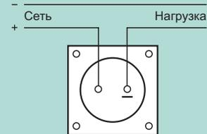
Схема непосредственного подключения амперметра и миллиамперметра.
