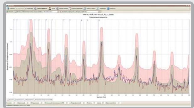
Образованный с помощью преобразования Фурье спектр сигнала тока, который применяется для определения механических и электрических дефектов роторной машины с помощью расчетных диагностических частотных интервалов и проявления гармонических составляющих.
