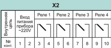
Для приборов с обозначением: Ф1764.1-АД-ХХ-3-Х-Х-2, Ф1764.1-АД-ХХ-3-Х-Х-3
