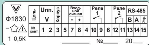
Схема внешних соединений прибора Ф1830 с оптоэлектронными реле, с интерфейсом.
