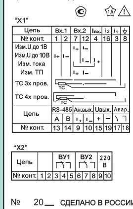
Для подключения к сети 24 В №конт. – 1, 2 "X2" соединителя «Сеть»
