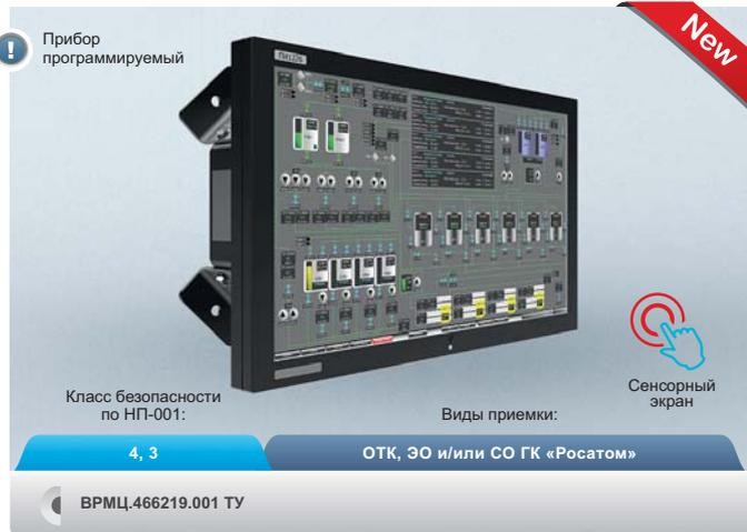
Панель информационная ПИ1226 представляет собой защищённый безвентиляторный компьютер-моноблок с сенсорным экраном, оснащённый промышленными интерфейсами.
