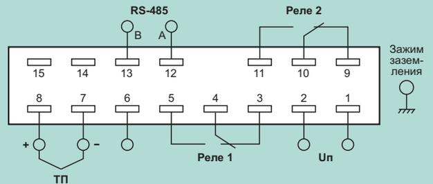
Схема внешних соединений приборов с термопарой (ТП).
