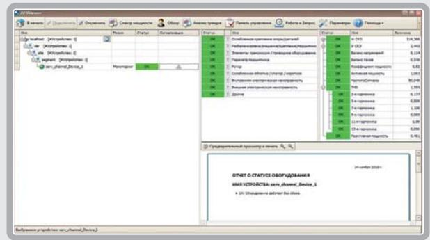
Панель оператора используется для текущего наблюдения за диагностируемым агрегатом. На ней отображаются значения физических параметров и информация о состоянии агрегата, в том числе сигнализации об обнаруженных неисправностях.
