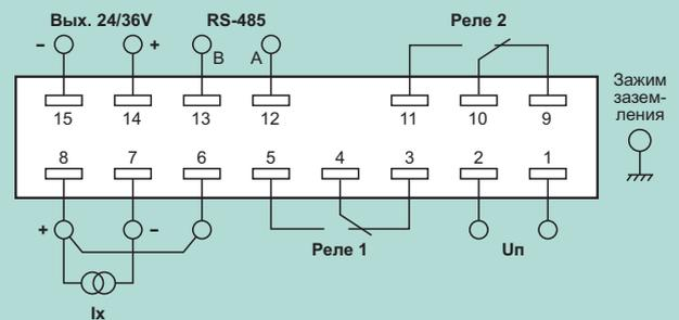
Схема внешних соединений приборов при измерении токов.
