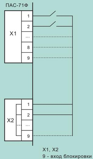
Подключение входных сигналов: ДС24В, входа блокировки.
