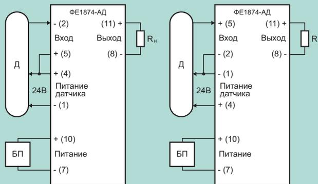
Схема подключения преобразователя с питанием внешнего датчика. Трёхпроводная схема подключения преобразователя к датчику. (ФЕ1874.1-АД-5-х ... ФЕ1874.1-АД-8-х)
