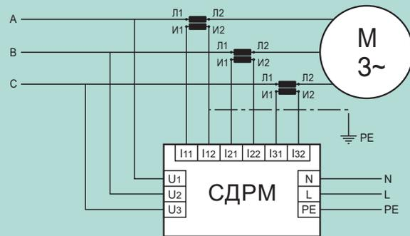
Подключение с трансформаторами тока и напряжения, напряжение свыше 0,4 кВ
