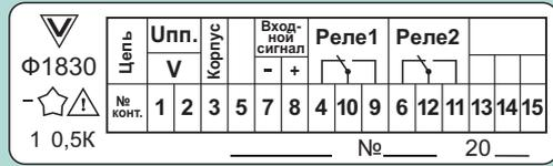
Схема внешних соединений прибора Ф1830 с электромагнитными реле, без интерфейса.
