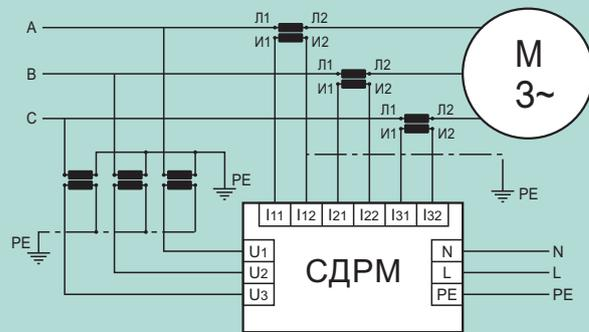
Подключение с 3-мя трансформаторами тока и 2-мя трансформаторами напряжения, напряжение свыше 0,4 кВ
