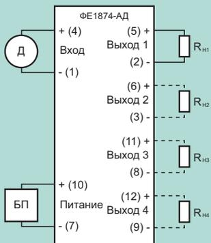
Схема подключения преобразователя без питания внешнего датчика. Питание датчика осуществляется от внешнего источника питания. (ФЕ1874.1-АД-1-х...ФЕ1874.1-АД-4-х, ФЕ1874.2-АД-х-х и ФЕ1874.4-АД-х-х)
